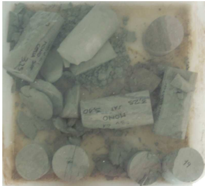
Figura 7: disgregazione dei provini durante le prove di imbibizione a pressione atmosferica.
