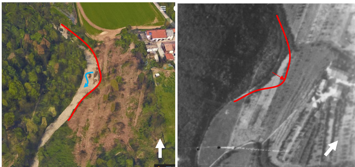
Figura 32: argine sinistro in erosione, in località C.na Campaccio. (Sinistra ortofoto Google 2016, destra foto aerea IGM 1936)
