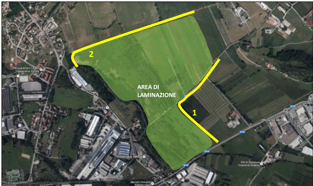
Figura 26 – linee arginali a chiusura dell'area di laminazione
