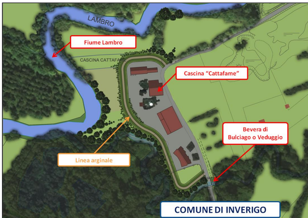
Figura 32 – Inserimento paesaggistico dell'intervento in progetto: argine a difesa della cascina "Cattafame"
