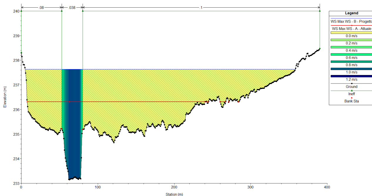
Figura 23 – Sezione di calcolo n.290: confronto tra il livello idrico in condizioni attuali (scenario "A", linea rossa) e in condizioni di progetto (scenario "B", linea rossa). E' evidente l'incremento di circa 1 m dovuto al fenomeno di rigurgito delle portate indotto dalla presenza dell'opera di regolazione.
