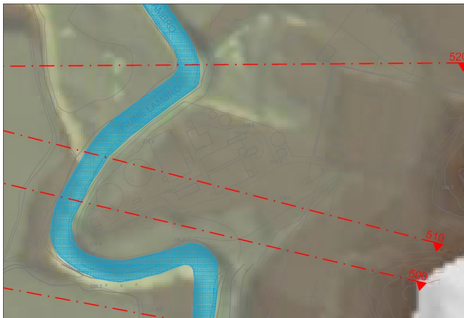
Figura 4 - Stralcio planimetrico che evidenzia le aree di esondazione nello scenario A (Rif. Tavola T.04 Aree allagabili – scenario A stralcio di monte, del progetto definitivo dell'area di laminazione di Inverigo).
