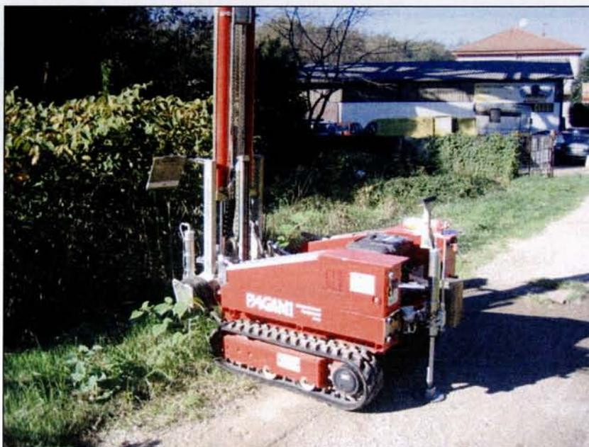
FIG. 11 Esecuzione prova penetrometrica dinamica SCPT 2
