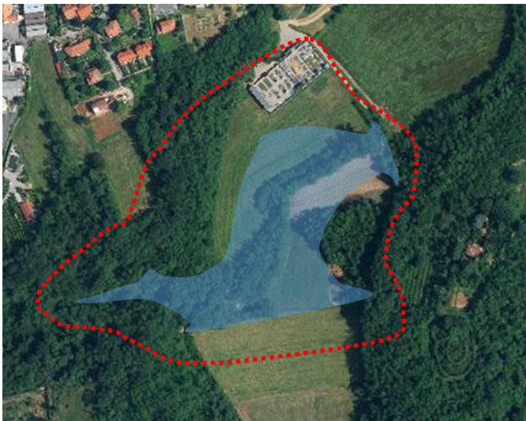
Figura 17: Area di Monte. In blu è indicata l'area di esondazione controllata. In rosso l'area di buffer.
